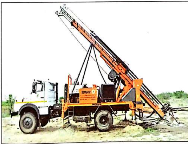
चित्र-4. खनिज अन्वेषण कार्य में लगी जीएसआई की ट्रक पर लदी हाइड्रोस्टैटिक ड्रिल मशीन
